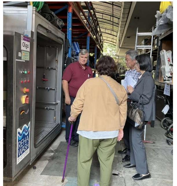
車椅子2~3台を中に入れて洗浄をする装置です。消毒液を使って殺菌も同時に行うことができ、その消毒液濃度も可変で選択できるようになっていました。洗浄して乾燥させるのに15分程度で完了するそうです。当会の現状の最大の悩みは洗浄です。このような装置を使用することで、車椅子を高効率に良い洗浄ができるだろうと思います。
