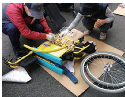
ブレーキやフットレストの点検 調整・交換
